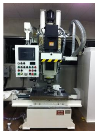
図 3 摩擦攪拌接合試験機
